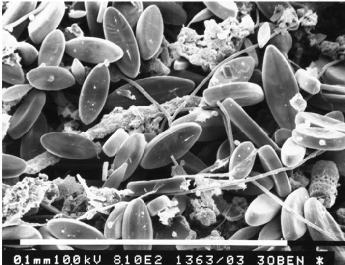
Abb.10: Rasterelektronenmikroskopische Aufnahme der Oberfläche eines schlickigen Sedimentes bei Niedrigwasser und im Tageslicht mit Belag epipelischer Algen (*Navicula pygmaea* und *Oscillatoria* sp.). Elbe bei Bielenberg. Quelle: Kies et al. 1992.
